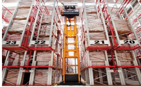
Şekil 14.13. Dar Koridorlu Depolama Sistemleri
